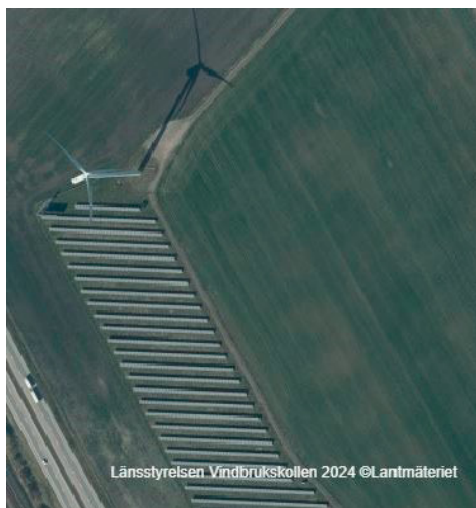
Figur 25. Markbaserad solcellsanläggning i anslutning till vindkraftverk.
