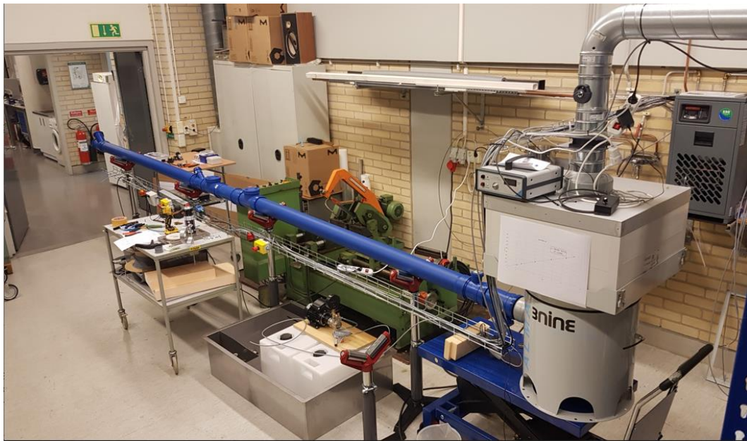
Figur 3. Försöksrigg för spray- och separeringstester i GDEV:s utvecklingslab.
