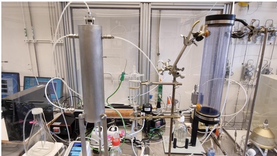
Figur 1. Absorptionsutrustning konstruerad av rostfritt stål. Glasabsorptionskammaren syns i mitten av bilden.
