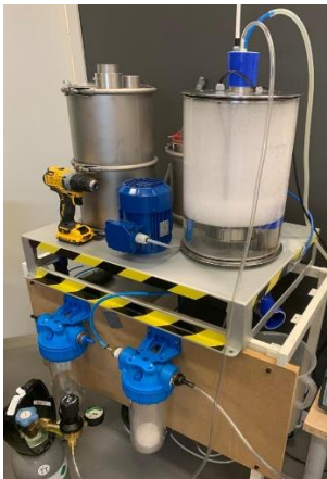
Figur 5. Laborarieuppställning för satsvisa absorptionsexperiment.
