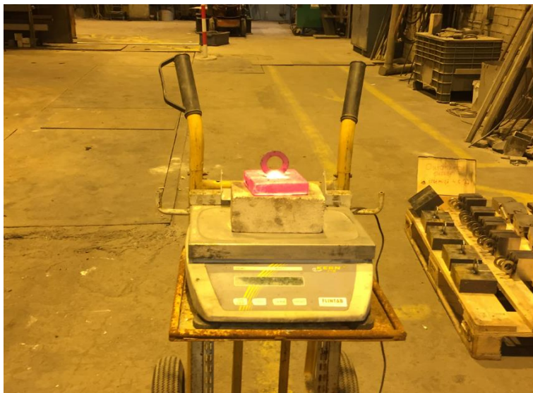
Figur 5. Vägning av prov direkt efter uttag från ugn.
