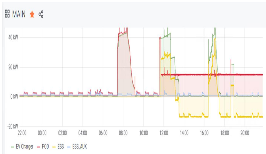
Figur 1. Visar effekterna av att utnyttja ett batterilagringssystem för att minska effekttopparna vid laddning av elbilar. Innan kl. 10:00 var batterilagret inaktivt. När en bil då laddades (EV Charger – grön graf) så uppgår den inkommande effekten från elnätet (POD – röd graf) till över 40 kW. När batterilagret aktiverats efter kl. 10:00, så visar grafen att batterilagrets effekt (ESS – gul graf) minskar effekttopparna från elnätet från 40kW till en konstant nivå på 15kW (POD – röd graf). När elbilar inte laddas så laddar batterilagret från elnätet (ESS – gul graf). Idag har batterilagret påvisat kapacitet att hålla
