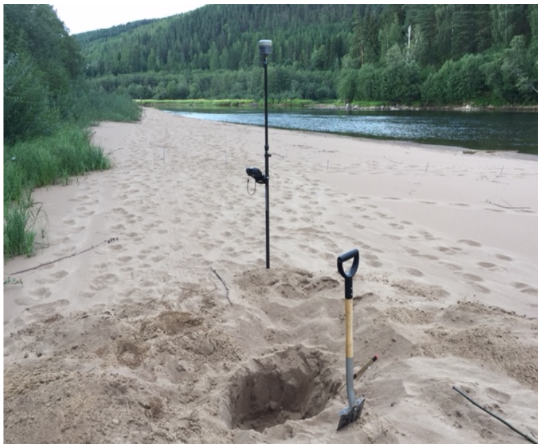
Figur 31. Upptagning av logger på Ginbergsängens depositionsområde. Loggern befann begravd under 0,66 m deponerad sand.
