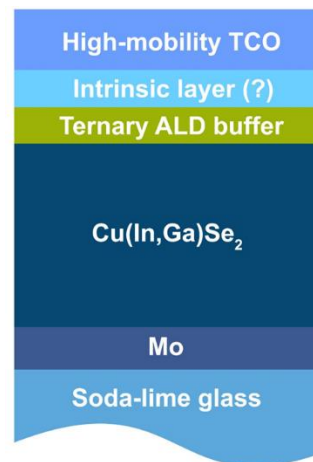
Figur 1: CIGS solcellsstruktur med ternära ALD buffertmaterial för god kontroll av optiska och elektroniska egenskaper. Genom att använda ALD buffertlager gavs möjligheten att ta bort det intrinsiska ZnO lagret från solcellstrukturen.
