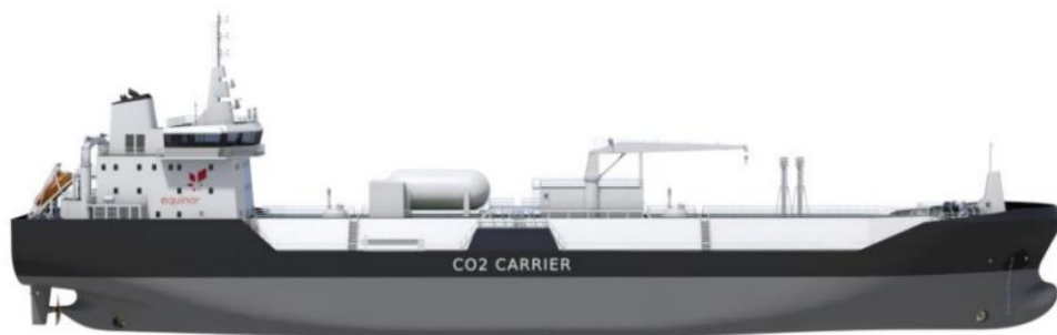
Figur 33 visar konceptbild av fartyg med kapacitet på 7500 m 3 . (Foto: Wärtsilä & Northern Lights)
