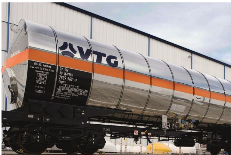
Figur 30 visar en vagn typ G66.081D från VTG avsedd för transport av kemiska gaser.
