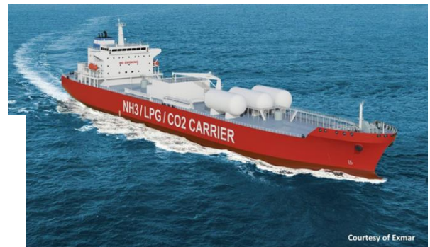
Figur 10 Exempel på fartyg med kapaciteten 7 500 m 3 koldioxid respektive 40 000 m 3 (195 m lågt vilket är max för Panamakanalen).
