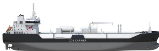
Figur 10 Exempel på fartyg med kapaciteten 7 500 m 3 koldioxid respektive 40 000 m 3 (195 m lågt vilket är max för Panamakanalen).
