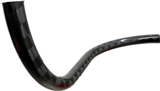
Figur 9 – Komplex krökt kompositrör för demonstration av nya tillverkningsmetoder
