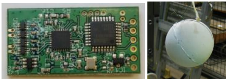
Figur 13. Till vänster visas ett kretskort för temperaturmätning och trådlös dataöverföring. Storleken på kretskortet är 18x35 mm. Till höger är kretskortet inmonterad i ett keramiskt isoleringsmaterial redo för att användas i ugnen. Systemet utvecklades i projektet DISIRE [1].
