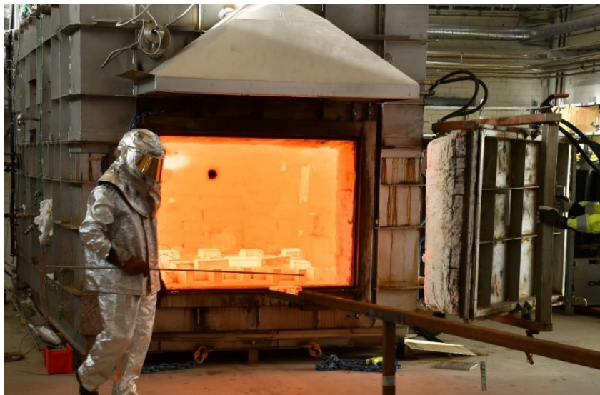
Figur 4. Vätgas-oxyfuel värmning av stålprovbitar hos Linde
