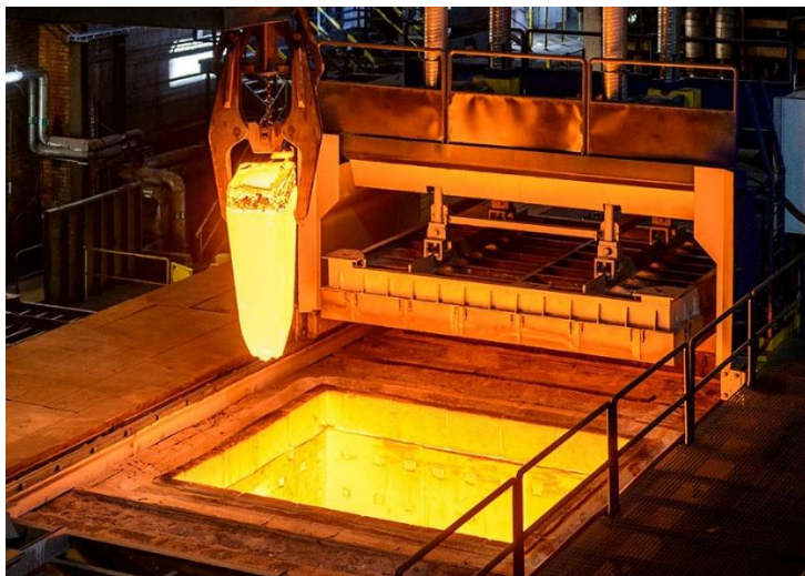
Figur 11. Varm göt som skall varmvalsas efter omvärmning
