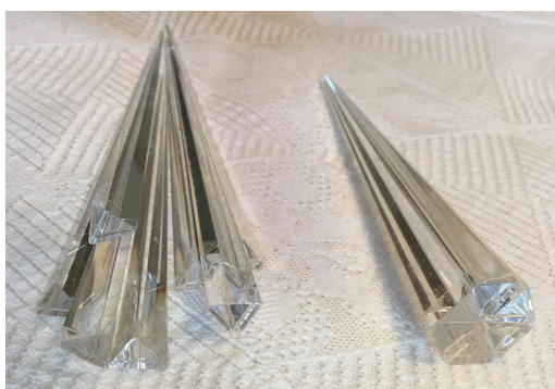
Figure 13a. Tillverkade HCPV koncentratorer med koncentrationsfaktor 100
