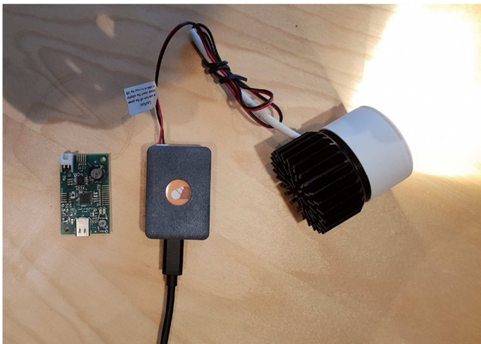
Bild x: USB-C LED driver som kan driva upp till 30W LED moduler.
