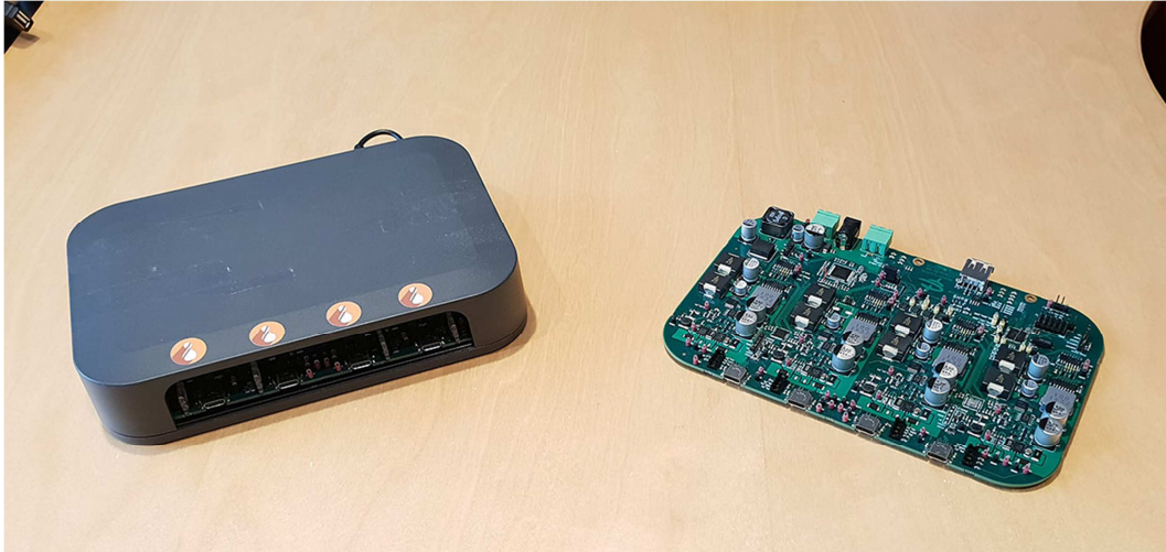
Bild x: Egenutvecklad hub med 4 USB-C portar som stödjer 100W (20V/5A) dubbelriktad elleverans / port.
