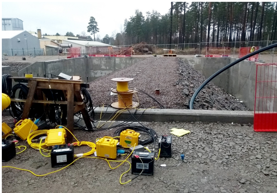
Figur 6: Seismograferna (gula lådor) används för att mäta vibrationerna från de inbyggda sensorerna och borrhålen längs dammkrönet som används för aktivt generera seismiska vågor.
