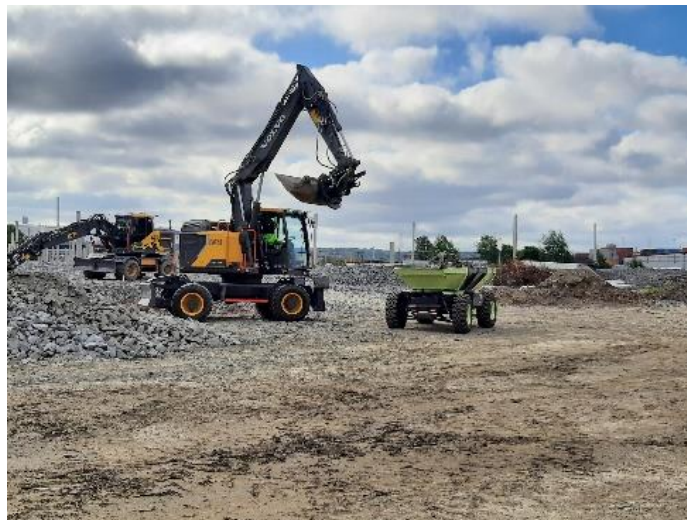
Figur 27 - Batterielektrisk större prototyp-hjulgrävare och fjärrstyrd lastbärare
