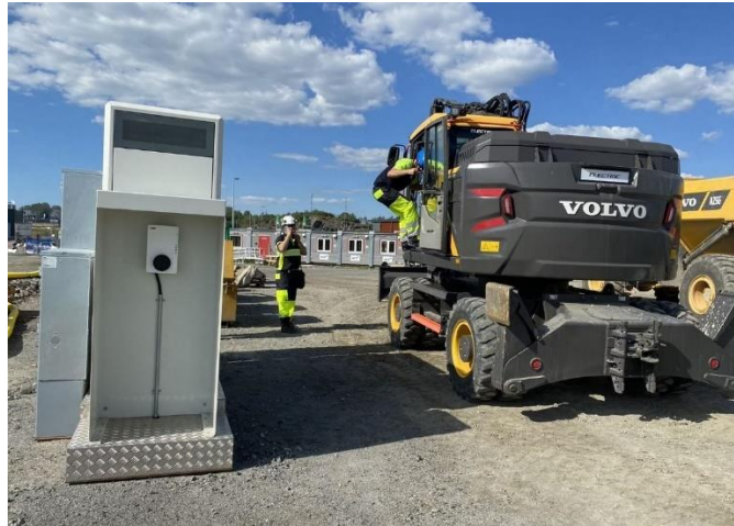
Figur 25 - Större batterielektrisk prototyp hjulgrävare och laddningsutrustning, Albatross
