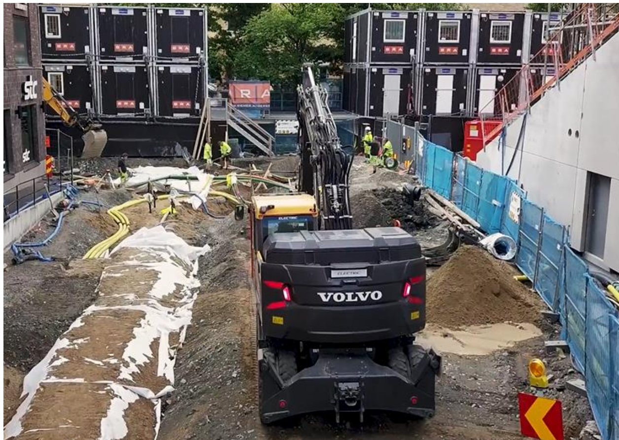
Figur 26 - Batterielektrisk större prototyp-hjulgrävare, bredvid Liseberg tillsammans med Göteborgs stad
