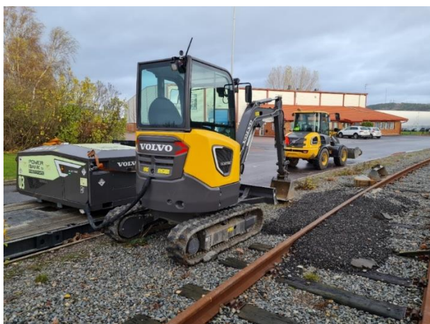
Figur 3 - ECR25 Electric & energilagrar, Ambulerande verksamhet, järnvägsunderhåll
