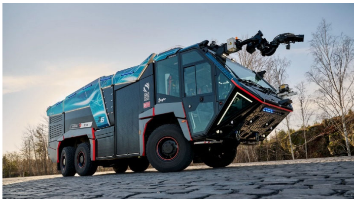
Bild 6: Scantias elhybriddrivlina installerad i ett Titan chassi för Albert Ziegler ARFF fordon. https://www.youtube.com/watch?v=HETGry-wuTM
