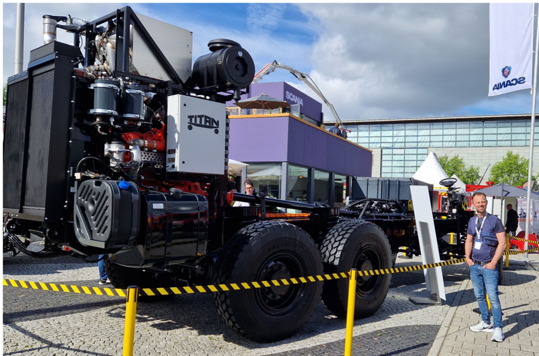
Bild 5: Utomhusbild på Titan chassit där Scantias drivlina i orange göms bakom olika "burkar", men där kardanaxeln i svart syns tydligt där den är ansluten till elmotorns utgående axel.
