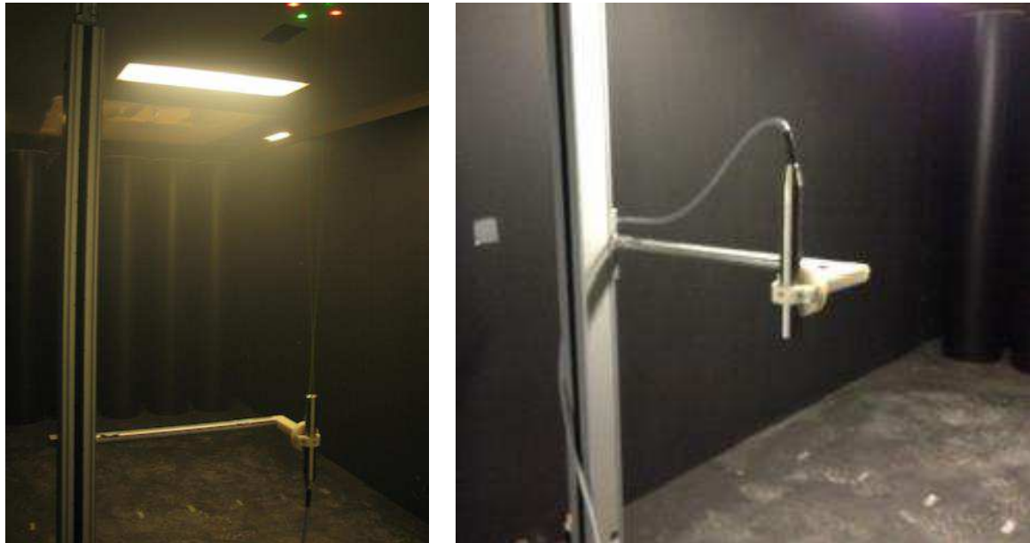
Figur 11 Montage av mätprobe och traverseringsanordning vid LDA-mätningar [2].
