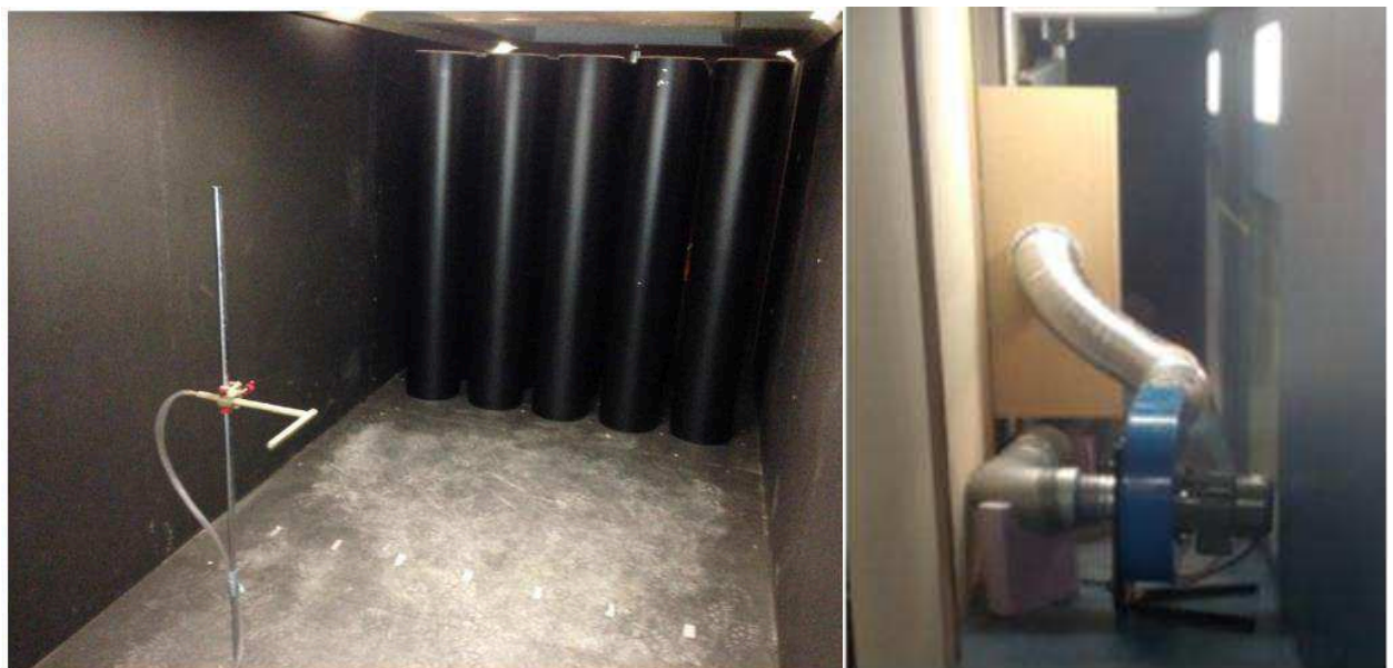
Figur 8 Paket med cylindrar (5x5) monterade i vindtunnel (vänster). Fläkt och tillhörande trycklåda för kylflötsinblås (höger) [2].
