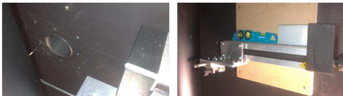
Figur 9 Positionering av varmfilmsprobe nära kyluftsinblåsens inlopp (vänster). Vägghalterat traverseringssystem (höger) [2].
