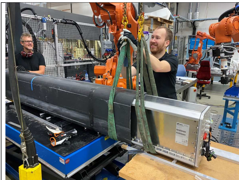
Sammanbyggnad av komplett balk med batteripack
