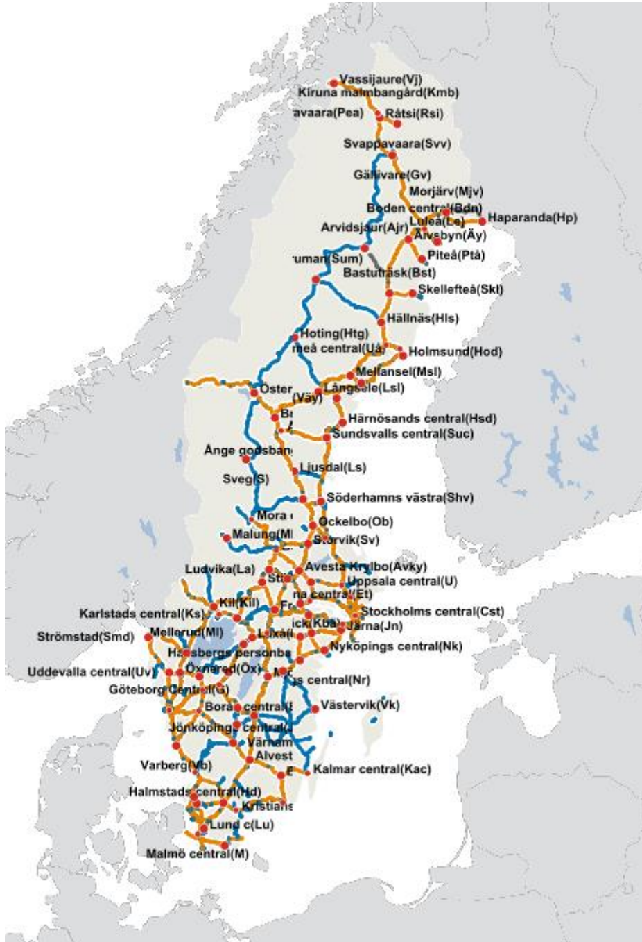
Figur 25 Banor med kontaktledning (orange) och banor utan kontaktledning (blå) (NJDB). 160
