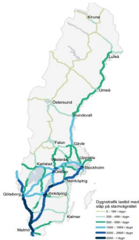
Figur 12. Kartan visar flödet av lastbilar med släp (>3,5 ton). I det ingår dragbil och semitrailer (inkl. "EU-långtradare" lastbil med påhängsvagn (≤16,5 m)). Trafikflödena baseras på Trafikverkets trafikmätningar, där olika vägsträckor har mätts olika årtal. Kartan är hämtad från Trafikverket. 67
