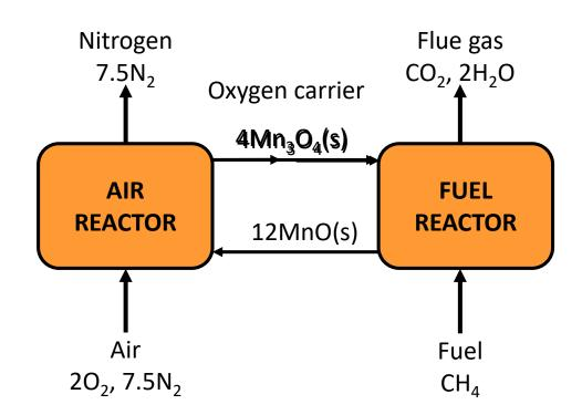
Fuel reactor:  $CH_4 + 4Mn_3O_4O(s) \rightarrow CO_2 + 2H_2O + 12MnO(s)$
