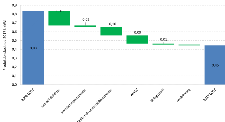
Figur 8. Faktorer som bidraget till reduktionen av produktionskostnaderna för vindkraft under perioden 2008—2017
